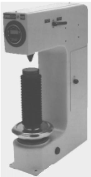
Pode-se realizar o ensaio de dureza Rockwell em dois tipos de máquinas, ambas com a mesma técnica de operação, que diferem apenas pela precisão de seus componentes.
